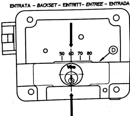
ASSE CILINDRO - CYLINDER AXIS - ZYLINDERACHSE - AXE DU CYLINDRE - CLINDRO
