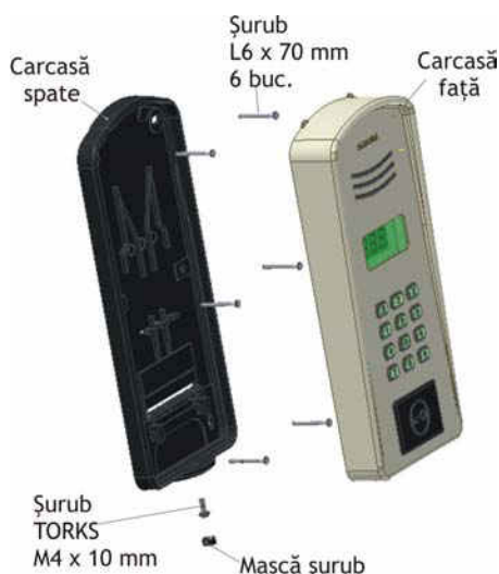
Fig. 2 Instalarea panoului exterior PES.A255
