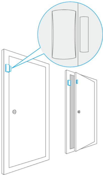
**Nota** Asigurati-va ca transmitatorul si magnetul functioneaza corect pe usa dumneavoastra. Daca se instaleaza pe o usa/ fereastră metalica trebuie sa creati un spatiu intre magnet/transmitator si suprafata metalica. Nu instalati acest contact pe o usa/geam cu ruluu.
