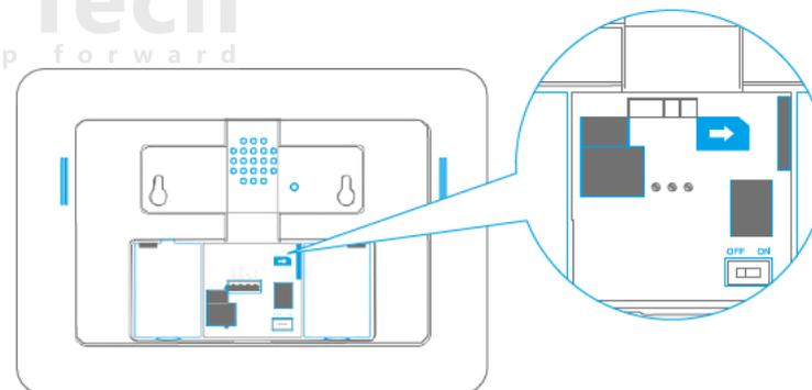
**Notă** Este necesară o cartela GSM SIM cu funcțiile normale (Apelare, răspuns, SMS și caller ID). Dacă utilizați Aplicația pentru a controla sistemul de alarmă prin GPRS, este recomandat să activați un plan GPRS la furnizorul de telefonie. Cartela SIM nu trebuie să aibă cod PIN. În cazul în care nu introduceți o cartelă SIM, panoul de control trimite doar alarma prin cablu de linie fixă
